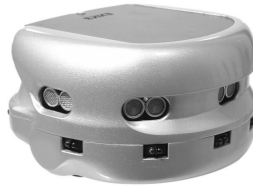
Rys. 1. Widok robota Khepera III
