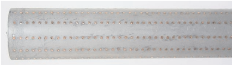
Rys. 8. Aluminiowa rura z miedzianymi sztyftami (punkty pomiarowe)
