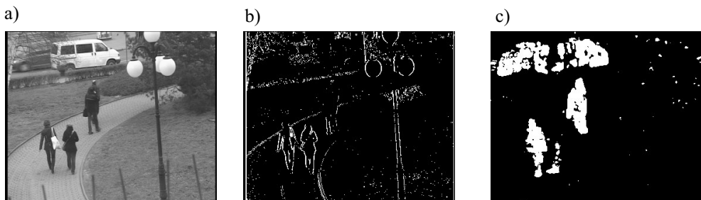
Rys. 6. Rezultat działania metod wykrywających ruch: a) oryginalna ramka; b) odejmowanie trzech ramek; c) przepływ optyczny Lucasa–Kanade’a
