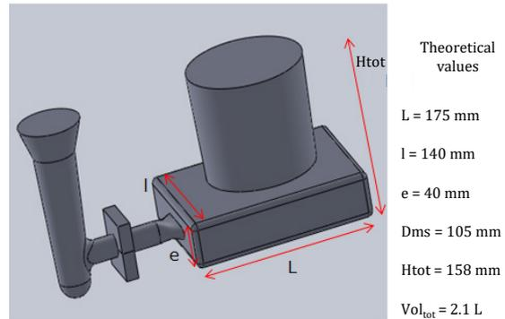
**Fig. 2.** Ingot dimensions
