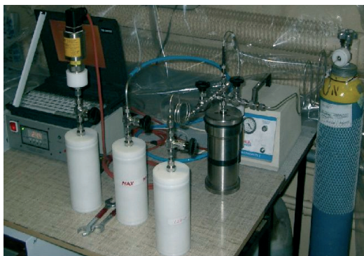
Rys. 1. Stanowisko do badania wpływu siarkowodoru na korozyjność cieczy nadpakerowych
