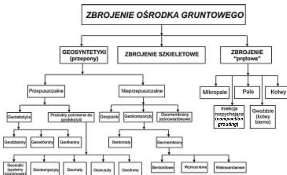
Rys. 6. Klasyfikacja typów zbrojenia ośrodka gruntowego [1, 6, 9, 11, 12]
