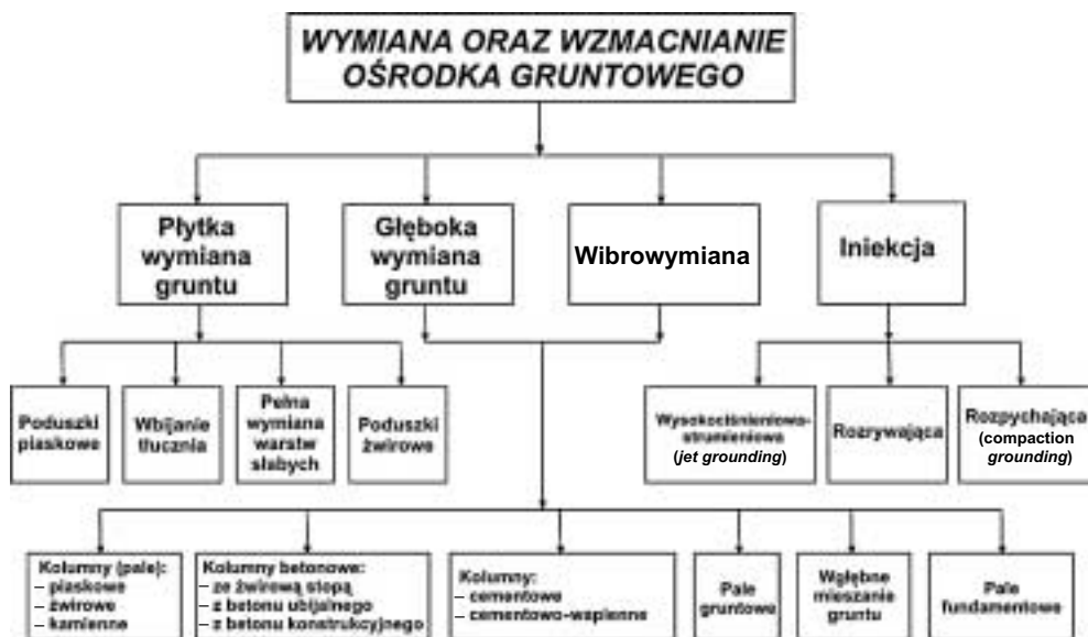
Rys. 5. Klasyfikacja metod wymiany oraz wzmocnienia ośrodka gruntowego [1, 2, 3, 4, 8]
