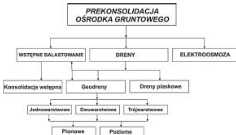
Rys. 7. Klasyfikacja metod prekonsolidacji ośrodka gruntowego [1, 9]
