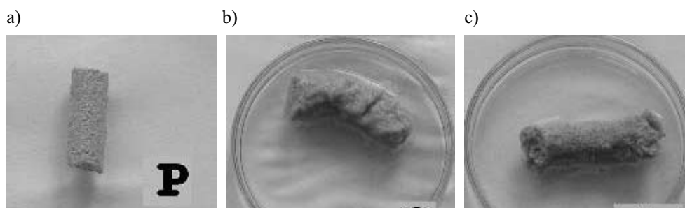
Rys. 5. Zdjęcia belecček QSE Pellets po oddziaływaniu badanych płuczek: a) belecčka porównawcza; b) płuczka M-XIX; c) płuczka M-XX
