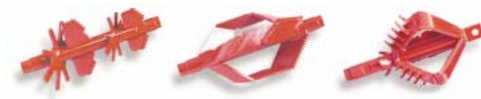
Rys. 8. Przykładowe konstrukcje rozwiertaków miksujących [3]
