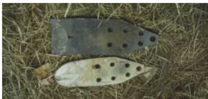
Rys. 10. Przykładowe zużycie łopatki urabiającej. U góry – łopatka nowa, u dołu ta sama łopatka po przewierceniu kilkunastu metrów w trudnych warunkach gruntowych [2]
