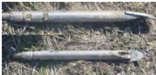
Rys. 2. Narzędzie wierzące z głowicą urabiającą ( fol. K. Banik )
