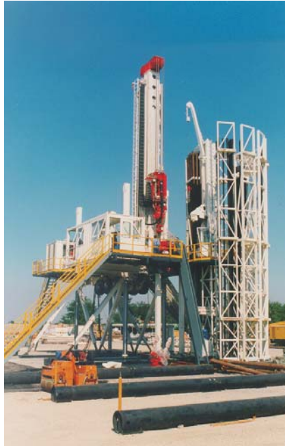
Fig. 4. HH-300 drilling rig
