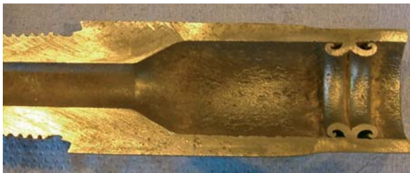
Rys. 1. Zdjęcie fragmentu rury płczkowej z rąbkami wewnętrznymi
