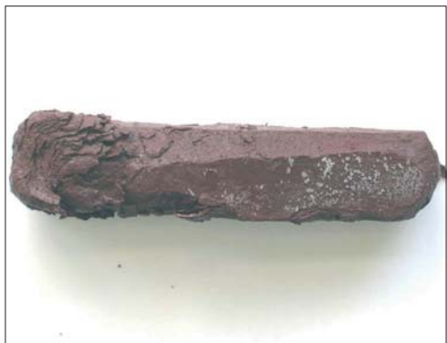
Rys. 4. Skład nr 2, solanka C, 95°C, 365 dni
