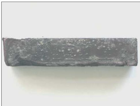
Rys. 5. Skład nr 1, solanka B, 120°C, 20 MPa, 365 dni
