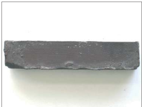
Rys. 6. Skład nr 2, solanka B, 120°C, 20 MPa, 365 dni
