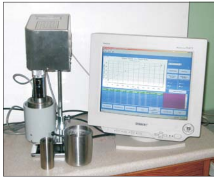
Rys. 7. Lepkościomierz obrotowy M3500 firmy Grace wraz z oprogramowaniem (model z lat 90. XX w.) Źródła własne
