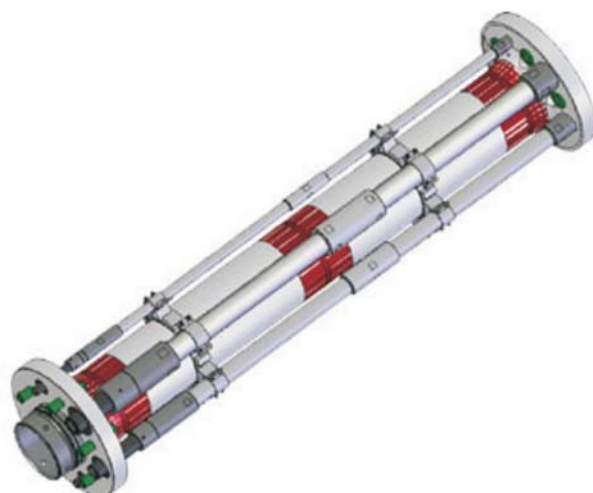
Rys. 4. Aluminiowy riser otoczony aluminiowymi przewodami serwisowymi [3]
