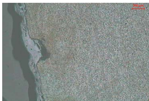
Rys. 13. Skorodowana powierzchnia wewnętrzna rury z widocznymi lokalnymi wżerami o głębokości ok. 0,3 \text{ mm} (rura nr 3')
