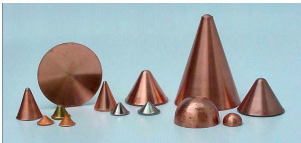
Rys. 11. Widok wkładek kumulacyjnych prasowanych z proszków metali [13]
