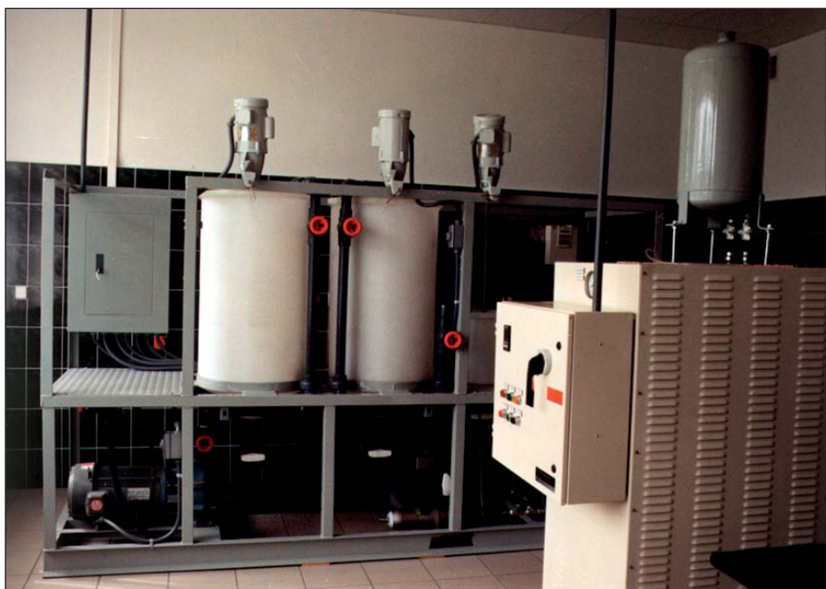
Rys. 2. Stanowisko do badań cieczy szczelinujących
