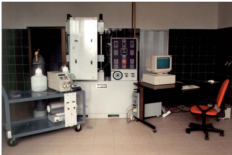
Rys. 3. Stanowisko do badań materiałów podsadzkowych
