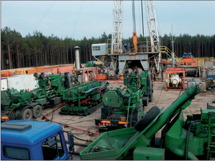
Rys. 10. Zabieg kwasowania matrycowego na złożu BMB
