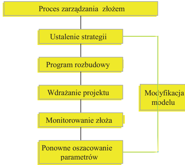
Rys. 3. Iteracyjny proces zintegrowanego zarządzania złożem ropy naftowej i gazu (Siemek, Nagy, Rybicki, 1995)
