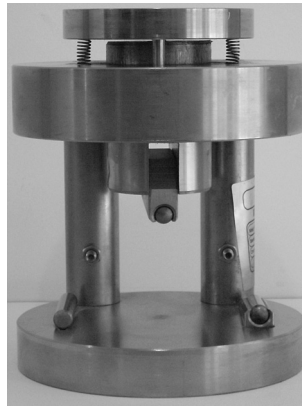
Rys. 4. Wkładka z układem obciążającym do oznaczania wytrzymałości na zginanie stwardniałych zapraw cementowych i skał
