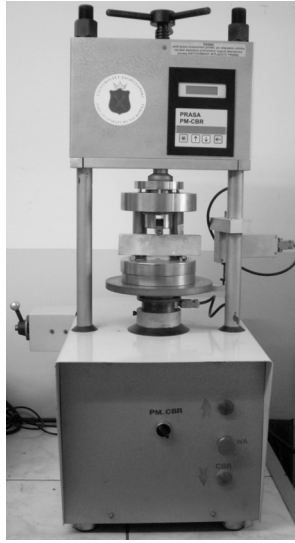
Rys. 3. Stanowisko do oznaczania wytrzymałości na zginanie stwardniałych zapraw cementowych i skał
