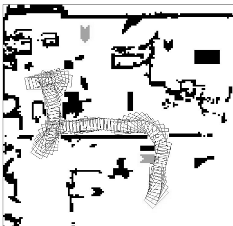
Rys. 5. Przykład nawigacji robota w środowisku z ruchomymi przeszkodami i ze zmianą trasy wynikającą z omijania ruchomej przeszkody
