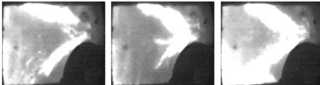
Rys. 5. Sekwencja obrazów zarejestrowana podczas spalania stabilnego przy zmniejszonym wydatku paliwa stałego
