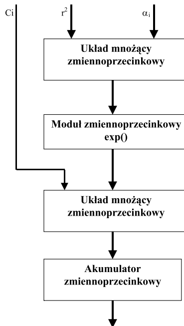
Rys. 2. Schemat blokowy modułu EP, która realizuje obliczenia funkcji orbitalnej
