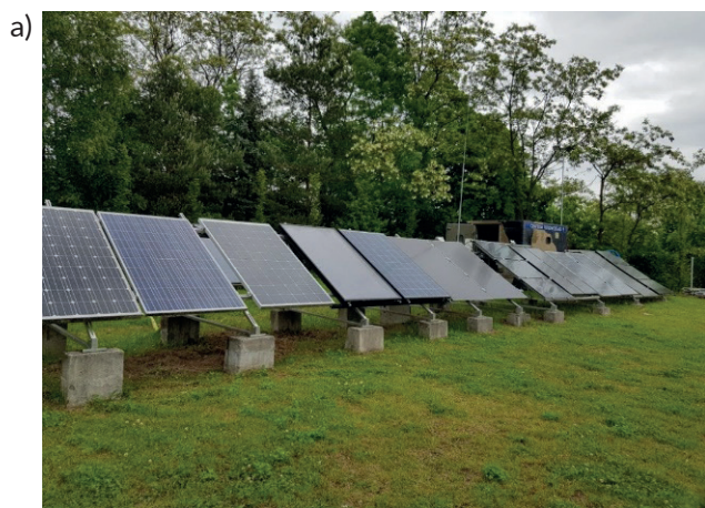
Rys. 1. Instalacje fotowoltaiczne w laboratorium terenowym: a) instalacja naziemna składająca się z jedenastu niezależnych torów pomiarowych; b) instalacja nadążna zlokalizowana w terenowym laboratorium fotowoltaicznym na terenie Centrum Zrównoważonego Rozwoju i Poszanowania Energii WGGiOŚ AGH w Miękinii
