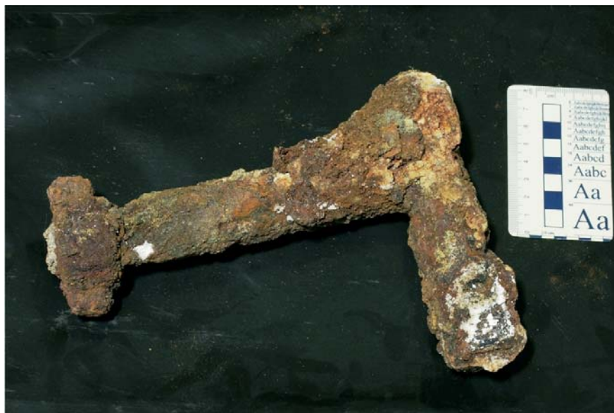
Fig. 2. Skorodowany fragment zaworu kopalnianego
