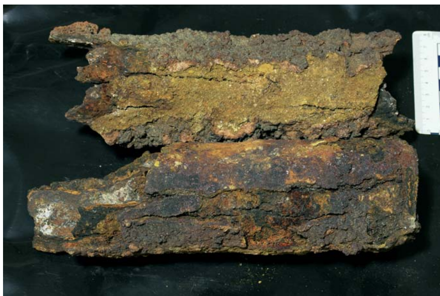
Fig. 3. Skorodowane fragmenty orurowania kopalni
