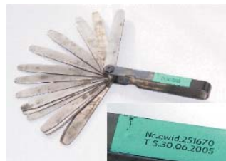
Rys. 4. Szczelinomierze do sprawdzania przylegania iglic do płyt ślizgowych
