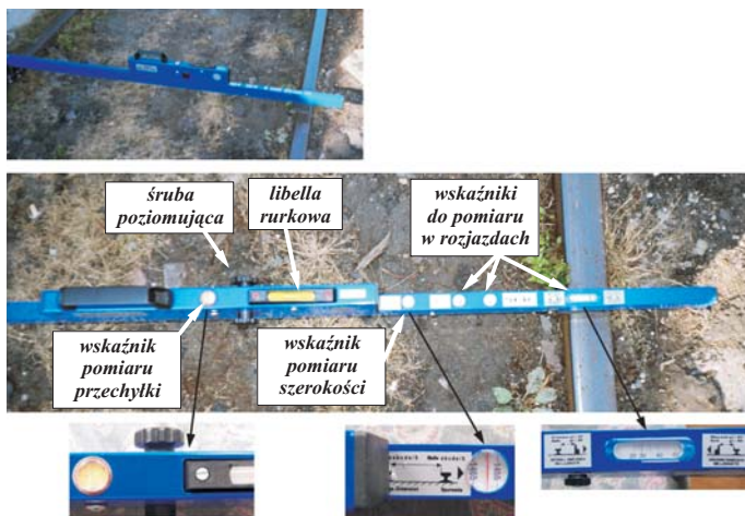
Rys. 2. Toromierz typu REMPOD TPK 1435 podczas pomiaru wstawki międzyrozjazdowej
