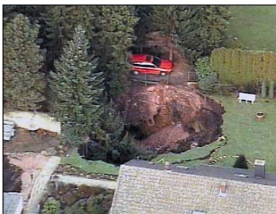
Rys. 1. Zapadlisko 1 w Bochum Wattenscheid-Höntrop, w pobliżu zlikwidowanego szybu IV kopalni „Vereinigete Maria Anna und Steinbank” [8]
