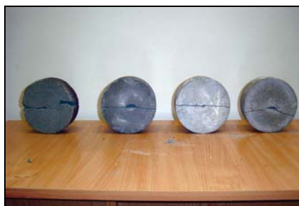
Rys. 12. Próbkki w chwili uszkodzenia
