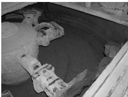
Rys. 1. Komora mieszania mieszarki przemysłowej „Utex”
