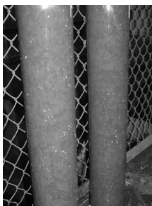
Rys. 2. Widok kolumn modelowych wypełnionych materiałem
