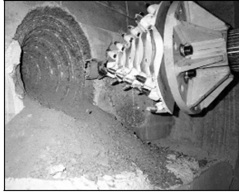
Rys. 3. Ogólna budowa i próby laboratoryjne świdra \varnothing 560P z obrotowymi wymiennymi nożami stycznymi
