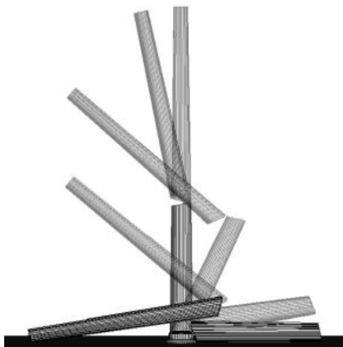
Rys. 8. Symulacja obalenia komina żelbetowego przez składanie. Wizualizacja
