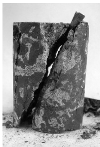
Rys. 7. Zniszczona próbka nr: złożo mineralne 38-1
