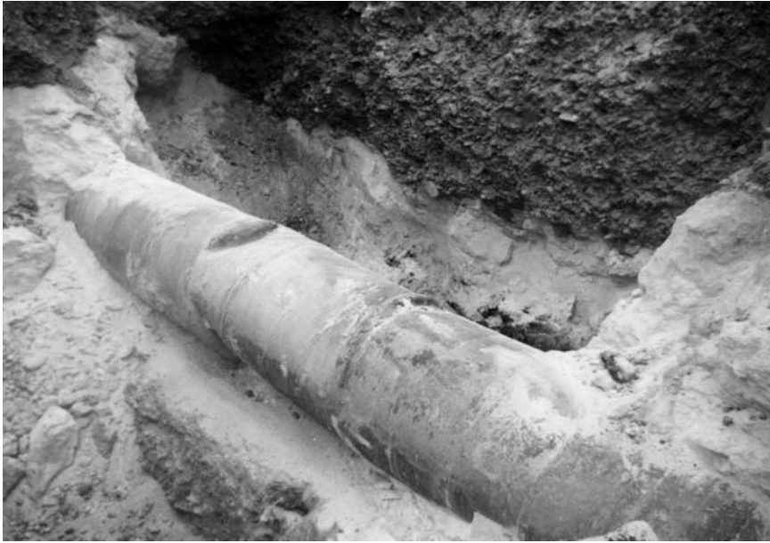
Rys. 11. Fałdy powstałe w wyniku sił ściskających
