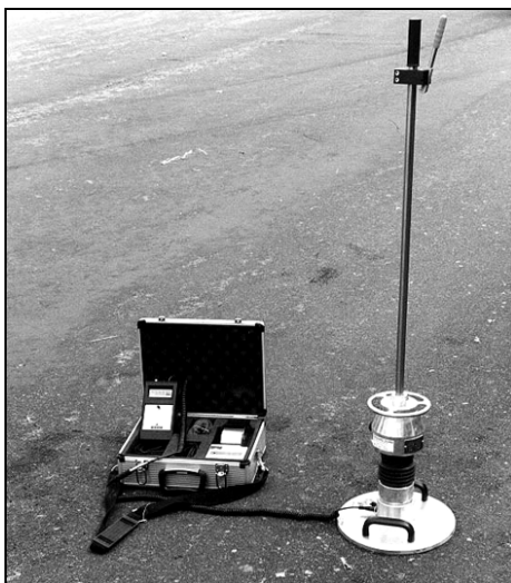
Rys. 3. Widok lekkiego ugięciomierza dynamicznego
