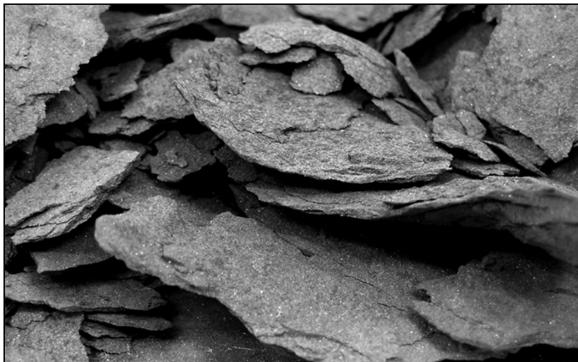
Rys. 1. Zdjęcie fragmentu mas powyrzutowych, które otrzymano w wyniku kontrolowanego wyrzutu węgla i gazu w warunkach laboratoryjnych. Kadr obejmuje powierzchnię o wymiarach około 10 \times 7 cm
