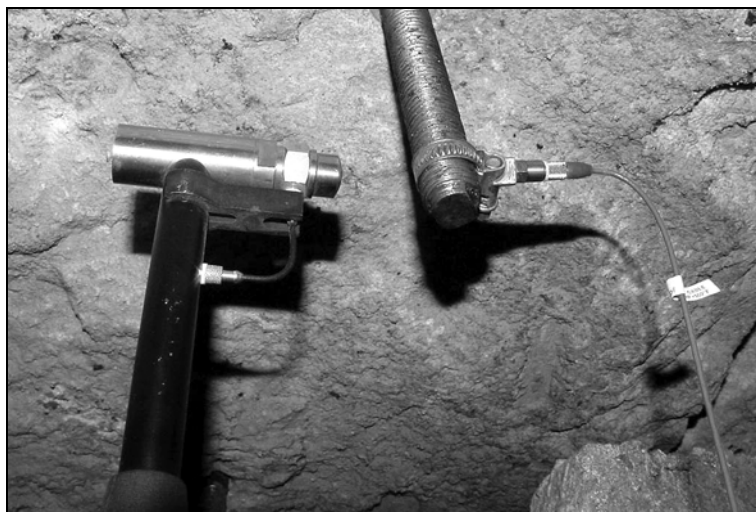
Rys. 2. Stanowisko badawcze w warunkach in situ — wymuszanie drgań młotkiem uderowym, sygnał odpowiedzi mierzony piezoelektrycznym przetwornikiem drgań
