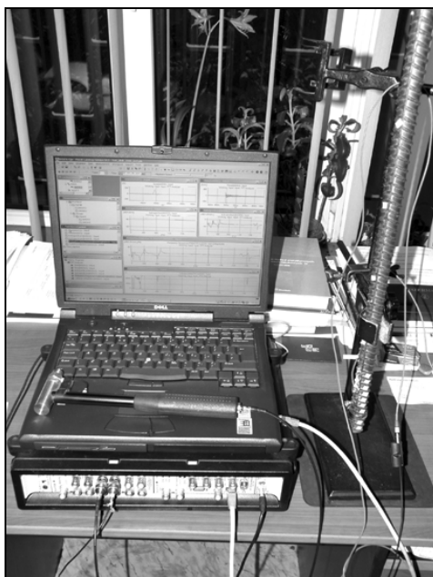
Rys. 4. Układ pomiarowy PULSE, firmy Bruel & Kjaer Dania, wykorzystany w badaniach walidacyjnych rejestratora sygnałów pomiarowych
