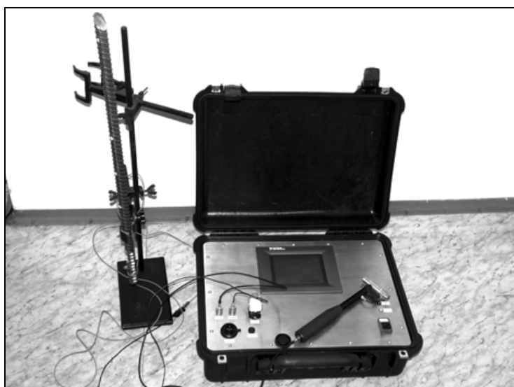
Rys. 3. Rejestrator sygnałów pomiarowych z ekranem dotykowym oraz bezprzewodową transmisją danych
