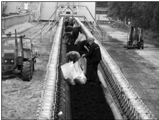
Rys. 3. Pobieranie próbek węgla w fazie skalowania popiołomierza
