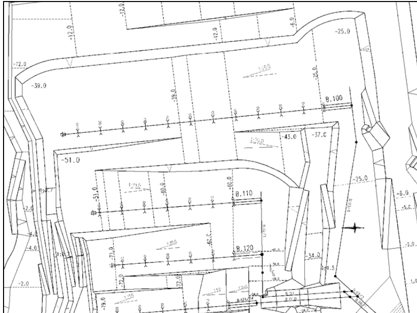
Rys. 4. Zakres urabiania koparką SchRs 4600 × 30 (projektowany stan robót poz. X, XI, XII na koniec 2010 r.)
