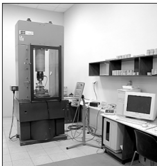
Rys. 1. Maszyna sztywna MTS-815 w Laboratorium Badań Pozniszczeniowych KGBiG AGH
