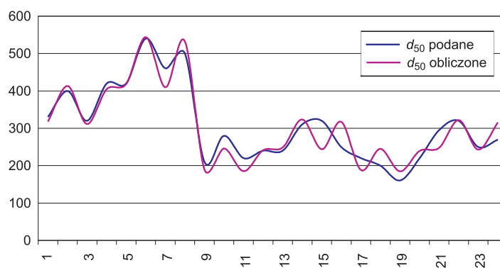
Rys. 2. Przebieg zmienności wartości d_{50} otrzymanych empirycznie (podane) i metodą algorytmów genetycznych
