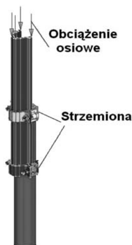
Rys. 1. Sposób badania złącza ciernego stalowych odrzwi obudowy przy osiowym ściskaniu oraz dyskretny model złącza
