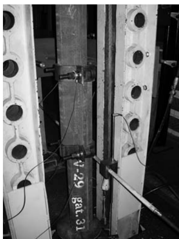
Rys. 1. Sposób badania złącza ciernego stalowych odrzwi obudowy przy osiowym ściskaniu oraz dyskretny model złącza
