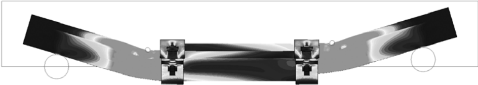
Rys. 5. Rozkład naprężeń zredukowanych oraz stan odkształcenia złącza ciernego przy obciążeniu wg PN-91/G-15000/11
