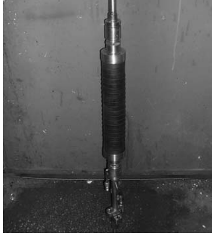
Rys. 1. Widok otworowej sondy pomiarowej
