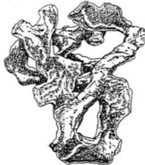
Rys. 1. Replika przestrzeni porowej w piaskowcu [4]
