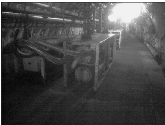
Rys. 2. Komora chłodziarek pośredniego działania w kopalni Darkov
