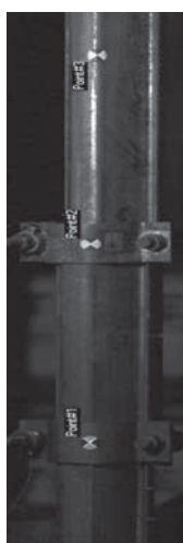
Rys. 5. Oznaczenie punktów i ich przemieszczenia w czasie zsuwu w złączu ciernym
