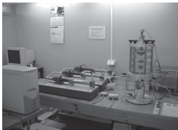
Rys. 2. Widok na aparat trójosiowego ściskania GDS
