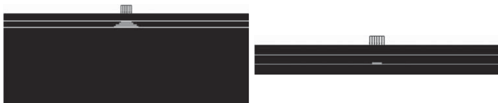
Rys. 5. Strefy plastyczności w warstwie podbudowy ( c = 70 kPa, \phi = 30^\circ ) dla modeli j.w.
