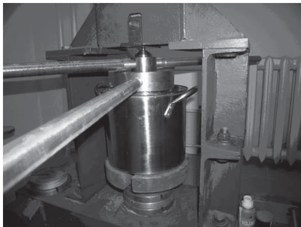
Rys. 2. Aparat do wyznaczania współczynnika parcia bocznego w ośrodku rozdrobnionym przygotowany do badania
