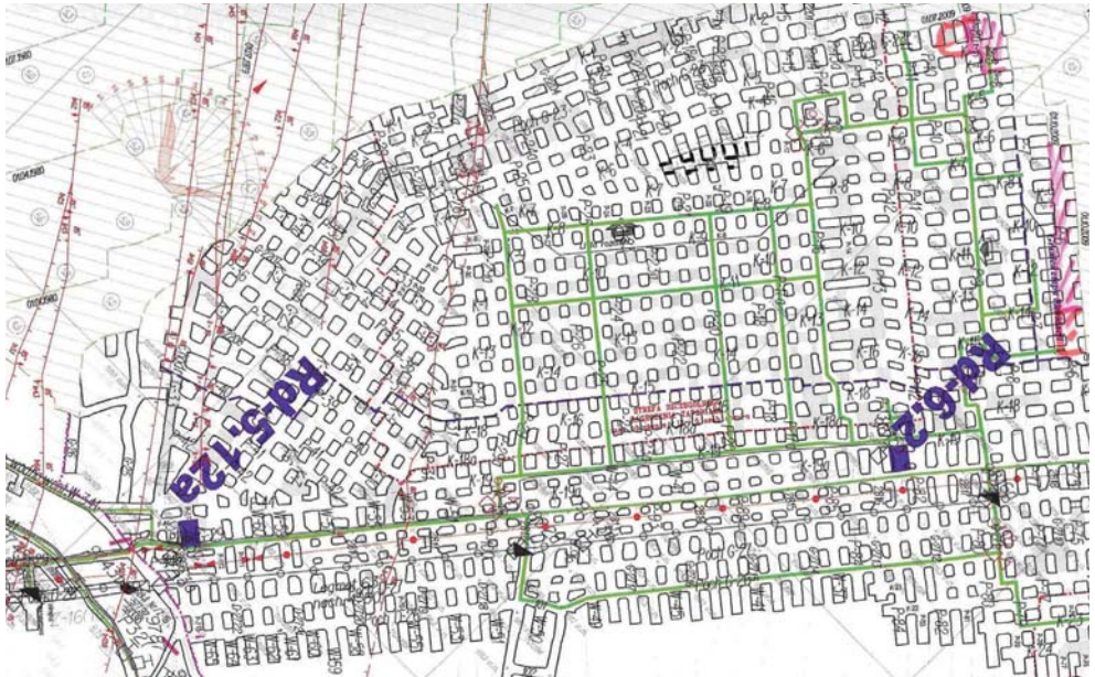
Rys. 4. Szkic wzrostek eksploatacyjnych w polu G po zakończeniu rozcinki resztki (widoczne wzrostki wypełnione skałą i drogi transportowe wewnątrz pola eksploatacyjnego)
