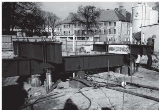
Rys. 5. Stanowisko badawcze z czujnikami zegarowymi i łatami inwarowymi
