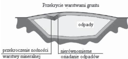
Rys. 1. Przekrycie warstwą mineralną odpadów
