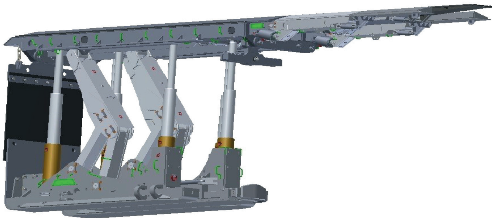
Rys. 3. Model obudowy zmechanizowanej skrzyżowania typu HENNLICH-20/43-CH
